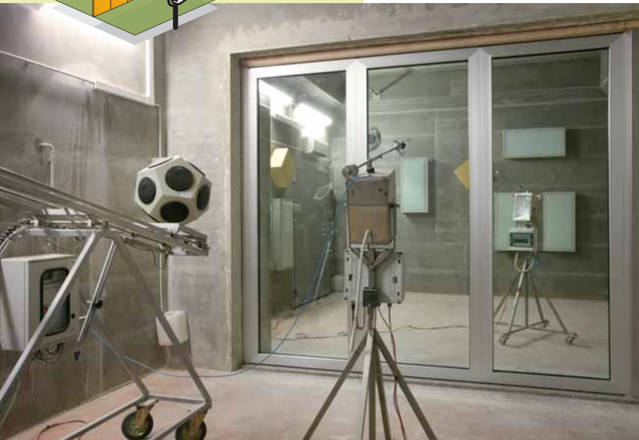
Test di isolamento acustico effettuato presso l'Istituto Giordano/Insulation test carried out at the Giordano Institute
