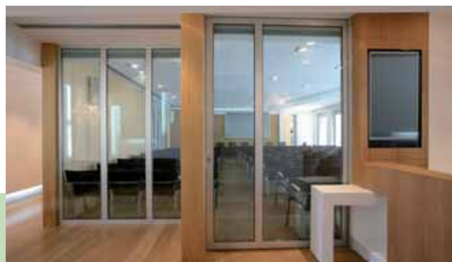
Dettaglio della parete manovrabile insonorizzata in vetro con tenda veneziana inserita/Detail of the movable sound-insulated glass partition with venetian blind inserted
